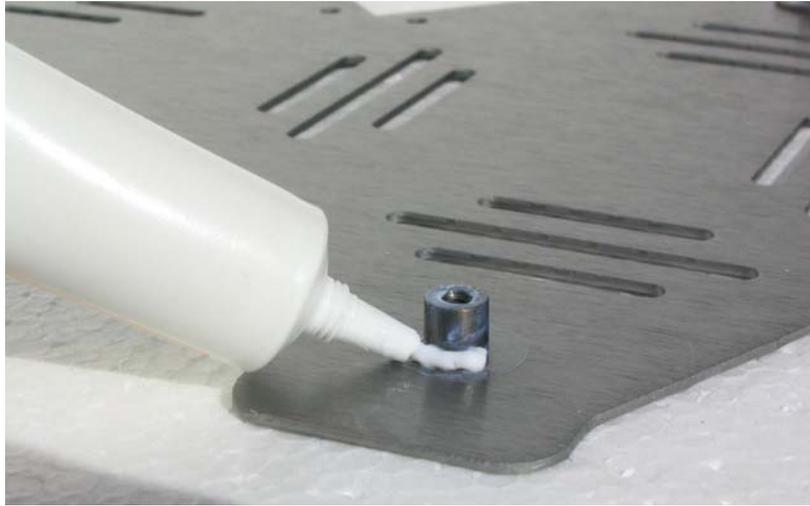
Figure 38: Grease Application – Pem Stud
